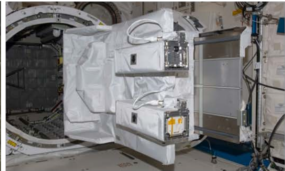
③ 軌道上で宇宙飛行士がバッグを開梱、衛星搭載ケースを含む放出機構をエアロックに取り付け(RBFピンなどの取り外しも実施)
