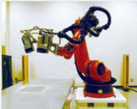
本システムは、供試体の3次元方向の振動特性を高精度で自動計測できる、航空宇宙分野では世界で唯一のシステムです。非接触式の3Dスキャニング振動計センサーをセンサー位置制御ロボットの先端部に搭載し、統合ソフトウェアによりロボット動作と計測を同期させることで自動計測を実現しています。計測に非接触式のレーザーを用いるため、精度の高い計測が可能です。
