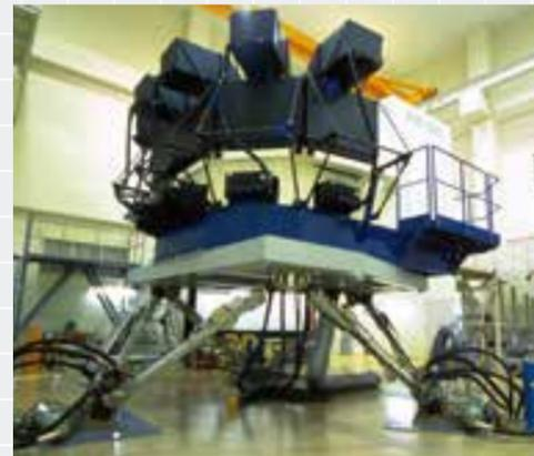
本飛行シミュレータ施設は3つのコックピットを有し、用途に応じてこれらを使い分けることでさまざまな実験が可能です。
