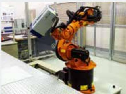
本システムは、供試体の振動特性を高精度で計測できるシステムで、多軸振動非接触自動計測システムを小型化したものです。非接触式のスキャニング振動計センサーをセンサー位置制御ロボットの先端部に搭載し、任意の場所の面外方向の振動計測を行うことが可能です。また非接触式のレーザーを用いるため、精度の高い計測が可能です。測定点の座標をはじめ、振動の時間履歴・周波数スペクトル・周波数応答関数など、さまざまな数値データを計測でき、グラフ化やアニメーション化はもちろんのこと、モーダル解析ソフトウェアと連携してモード特性も解析することができます。現在、ロボットと連動した完全自動計測はできませんが、振動計センサーのスキャニング範囲内であれば、自動計測が可能です。
