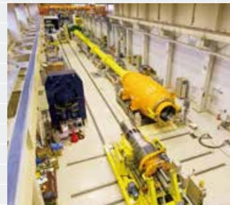
宇宙ステーションからの帰還カプセルが大気圏に再突入するとき、機体周りの空気は著しく加熱圧縮され、10,000度を超える温度になります。高温衝撃風洞はこのような超高速気流条件を作り出す設備では世界最大、最高性能で、世界で唯一、再突入の状態を地上で再現できる設備です。本設備では温度が10,000度以上、圧力が1,500気圧の空気流を発生させることができ、それを用いて再突入カプセルやスペースプレーン、複合エンジン模型などの試験や研究を進めています。
