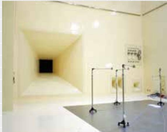
ロケットの発射時および飛行中のフェアリング内の音響環境を模擬し、その環境下での供試体機能を確認するものです。試験室は反響室(または残響室)と呼ばれ、分厚いコンクリートで覆われた一種の共鳴箱となっており、試験に必要な音響は、通常のスピーカーでは出力不足のため、音響変換器と呼ばれる特殊な装置を用いて発生しています。
