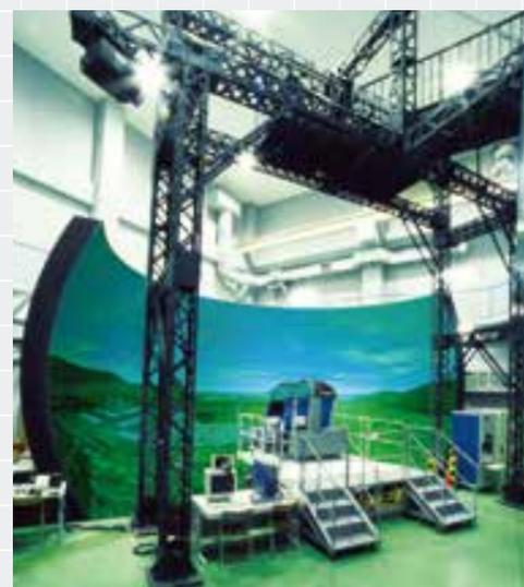
本飛行シミュレータ施設は3つのコックピットを有し、用途に応じてこれらを使い分けることでさまざまな実験が可能です。
