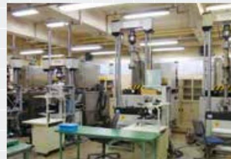
デジタル制御の油圧サーボ型材料試験機で、試験片および構造物の静的試験および疲労試験に使用します。最大負荷容量は±100kN~±10MNとなっています。
