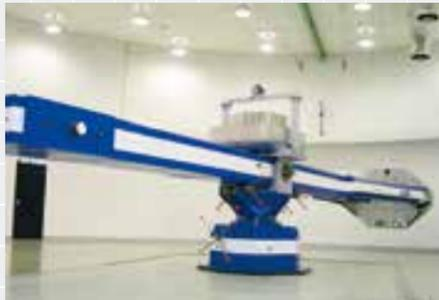
ロケット・人工衛星のサブシステムおよびコンポーネント、および航空機の搭載機器等に打ち上げ・飛行時等の静的加速度を負荷し、その耐性を試験し性能を確認する設備。加速度環境は旋回腕の旋回運動による遠心力を利用して得られます。供試体は、腕の一端にある供試体取付面に設置され、供試体の加速度は腕の回転によって制御されます。加速度試験中の計測信号は、回転中心部に設置された計測架から無線伝送し、加速度計測室でモニタ・記録できます。また、最大14日間の連続試験ができ、震度5強以上の地震発生時は旋回腕は自動停止します。
