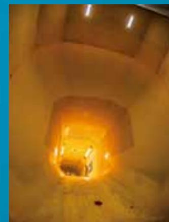
「6.5m×5.5m低速風洞」内部の“縮流洞”と呼ばれる部分。15m×12.5mの断面から入る空気の流れを測定部の6.5m×5.5mまで急速に絞ることで乱れを抑える。
