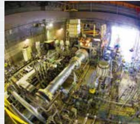
地球と宇宙を航空機のように往復するスペースプレーンは人類にとって夢の宇宙輸送機です。このスペースプレーンの実現のためには、空気を使いながら超高速で飛行できるエンジンが必要となります。また太平洋を数時間で横断するような超高速輸送のためにも、やはり超高速用のジェットエンジンが必要となります。この設備はマッハ数4、6、8の飛行速度でラムジェット、スクラムジェット、複合エンジン、極超音速ターボジェットなどのエンジンの燃焼試験ができる、我が国初のエンジン試験風洞です。本設備の完成は平成5年度で、試験能力は世界トップクラスです。
