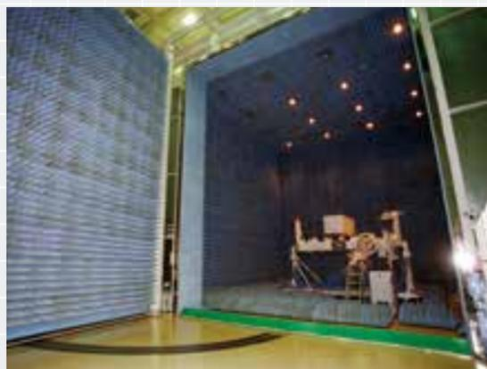
ロケット・人工衛星に搭載する電子機器等の電磁気的相互干渉による機器の機能低下の有無を確認する設備です。設備の構成は、電子機器等を外來雑音電磁波から遮断するシールドルーム並びに電子機器等との間で電磁波の受信または放射を行うアンテナ部および受信部等からなります。これらの試験設備を使用して、米軍規格(MIL-STD-461等)および国際宇宙ステーションからの要求(SSP30237)に対応したレベルでの試験が可能です。
