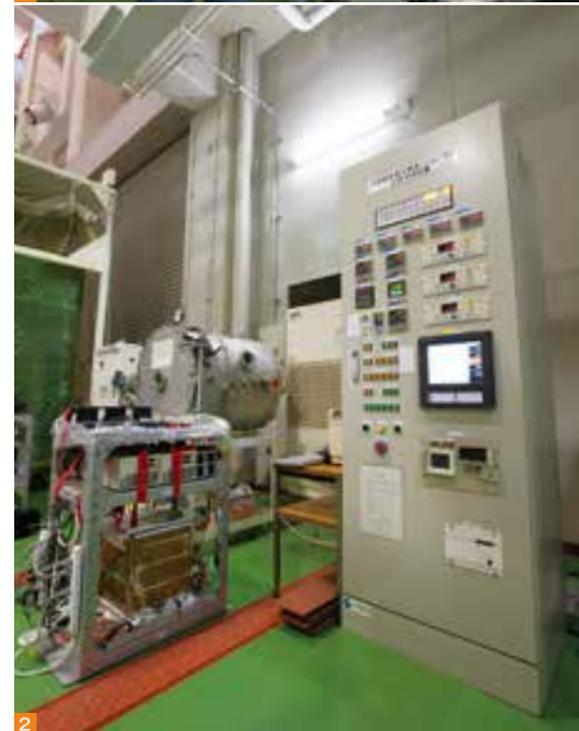
「宇宙空間は遮る空氣が無いので、太陽光が当たっているところは非常に熱く、当たらないところでは温度が極端に下がる傾向があります。人工衛星や惑星探査機は、特殊な宇宙環境下でも、温度がなるべく快適に保たれるように設計を行います。この設計がうまく行われていることを確認するために試験を行っています。人工衛星や惑星探査機がロケットで打ち上げられる直前の最終的な試験もここでいきます」と小川准教授。
