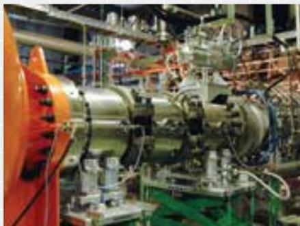
本設備はガスタービンの燃焼器やその要素技術を実際の機械と同じ高温・高圧力条件下で試験するために導入されたもので、試験部最大圧力が5MPaの高圧系(2系統)と1MPaの中圧系、3系統があります。現在も高性能の産業用ガスタービンやジェットエンジン燃焼器の研究開発に使用しています。多数の温度・圧力に加えて排気ガス成分(窒素酸化物、未燃燃料、一酸化炭素、煤等)の計測が可能で、燃焼器の環境性も含めた総合的な性能を計測できます。
