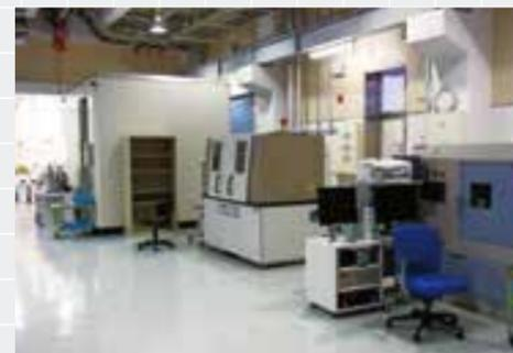
複雑形状あるいは肉厚の複合材構造の非破壊評価を実施するために導入されました。これまでにロケットや衛星の推進系ノズル、航空機のタービンブレード、鋳造品等の検査をはじめ、複合材や金属の各種供試体に適用されています。X線CT探傷装置では、サイズが最大φ600mm×高さ1200mmまでの大型供試体の探傷が可能です。また、マイクロX線CT探傷装置では、最大φ200mm×高さ300mm程度までの供試体の探傷が可能で、最善の条件であれば5μm程度(断面サイズがφ5mmの場合)の欠陥、損傷が検出可能です。
