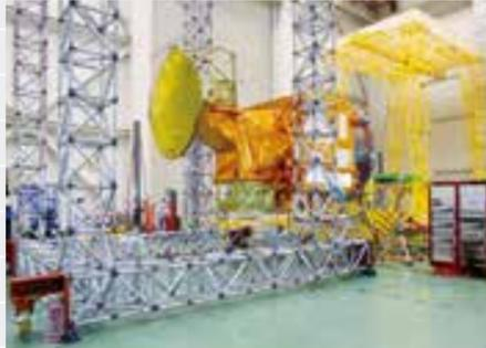
人工衛星が最終段ロケットから分離される際やアンテナ等が展開される際の火工品作動による衝撃環境を地上において模擬し、衛星が受ける衝撃レベルを測定・解析する設備。設備は、爆管制御部・計算機部・アナログ処理部・デジタル処理部等から構成されています。爆管制御部は、衛星を分離させる火工品に点火電流を流すと共にデジタル処理、高速度カメラを制御します。衛星に取り付けられた加速度センサからの信号は、JBODに記録され、計算機にUPLOADしたのち、フーリエ変換・衝撃応答スペクトラム解析の処理が行われます。また、分離の様子は、高速度カメラによって撮影することができます。
