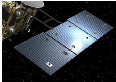
従来の展開型太陽電池パドル (出力質量比50W/kg程度)
