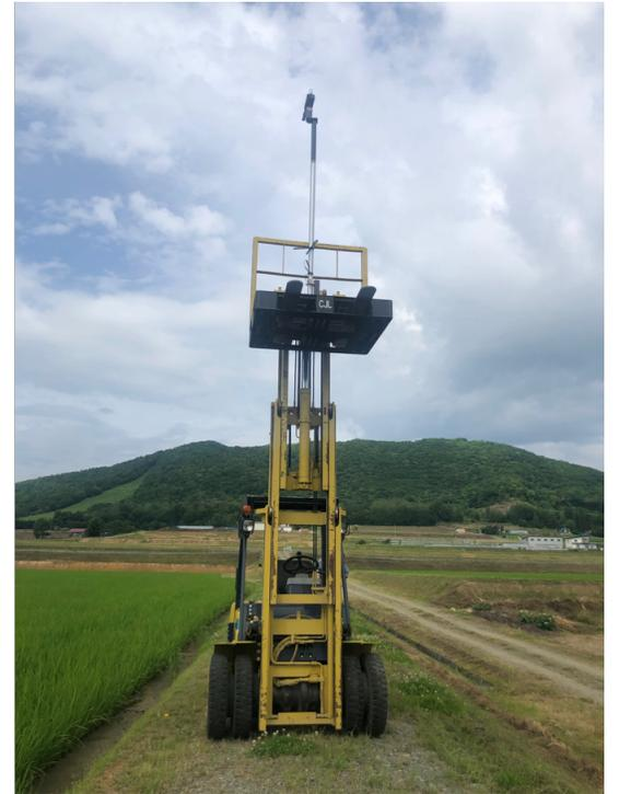
電動ジンバルを用いた、牧草および稲の計測
