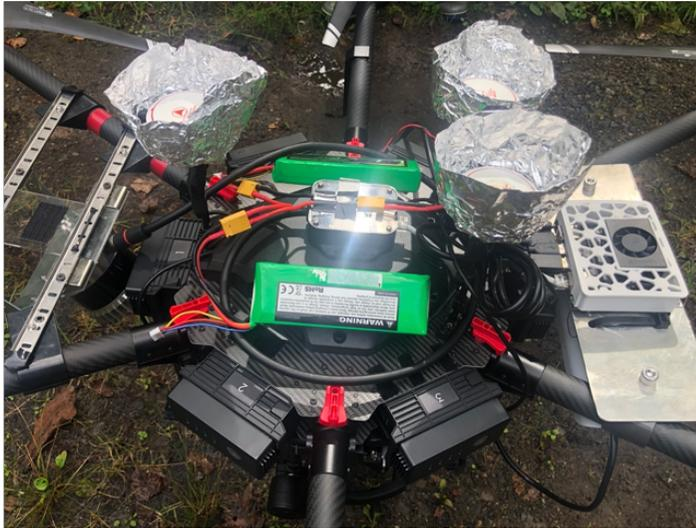
ライダーと小型分光器によるドローン計測
