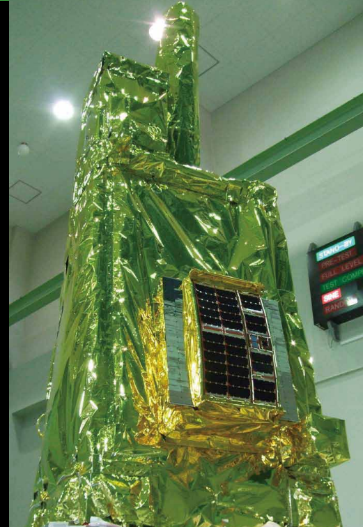
惑星分光観測衛星と搭載される次世代電源系機器NESSIE(左の写真の中央)。黒い部分が薄膜多接合太陽電池(左右に展開される太陽電池パネルは、従来の3接合太陽電池)
