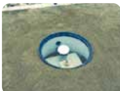
埋め込みタイプのGPSセンサー
