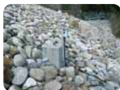
GPSセンサーをダムに設置して変位を計測する
