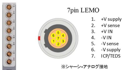
図 3-2 計測解析装置 計測センサインタフェース（歪）
